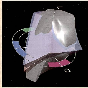
Die Farbraumdarstellung in ProfileMaker zeigt, dass die profilierte Digitalkamera (grau) deutlich mehr Farben erfasst, als sich in den Arbeitsfarbräumen Adobe RGB (rot) und eciRGB v2 (blau) beschreiben lassen.
