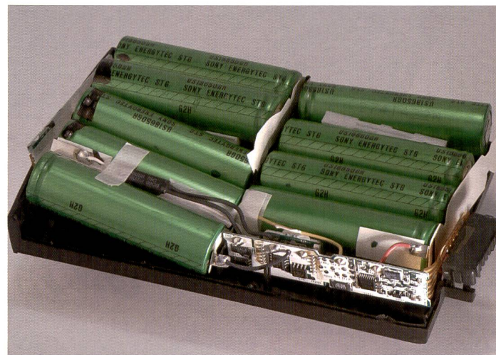
Vie intérieure d'un accu lithium-ions d'ordinateur portable: plusieurs cellules sont branchées en batterie. Le nouvelle technologie lithium-polymère offre une flexibilité de forme qui débouche sur des éléments plus souvent plats.
