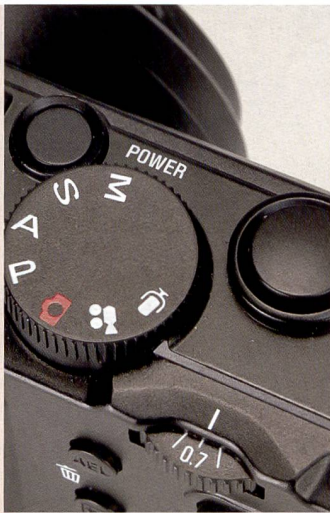
Le Sigma DP1 permet de nombreux réglages manuels. L'une de ses particularités est la molette de mise au point avec le pouce.
