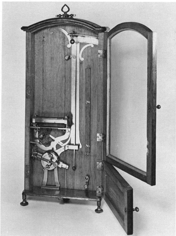
de n'avoir pas embarqué l'appareil que Saussure a appelé magnétomètre et que j'avais fait construire par M. Paul à Genève»<sup>15</sup>.
