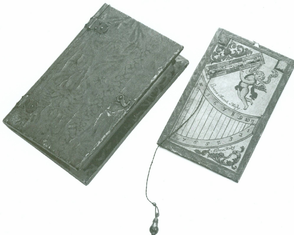
Cadran solaire analemmatique particulier, dit « capucin », signé « MAINTRY FECIT » (XVII e ou XVIII e siècle). Musée d'histoire des sciences, Inv. 2154
