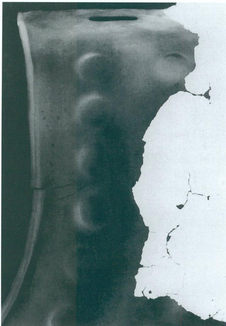
3 a, b, c. Détail de l'emmanchure gauche de la dossière: a, état visible à l'œil nu | b, mise en valeur de la résine de comblement (50 kV) | c, mise en valeur de l'état du métal (95 kV)
