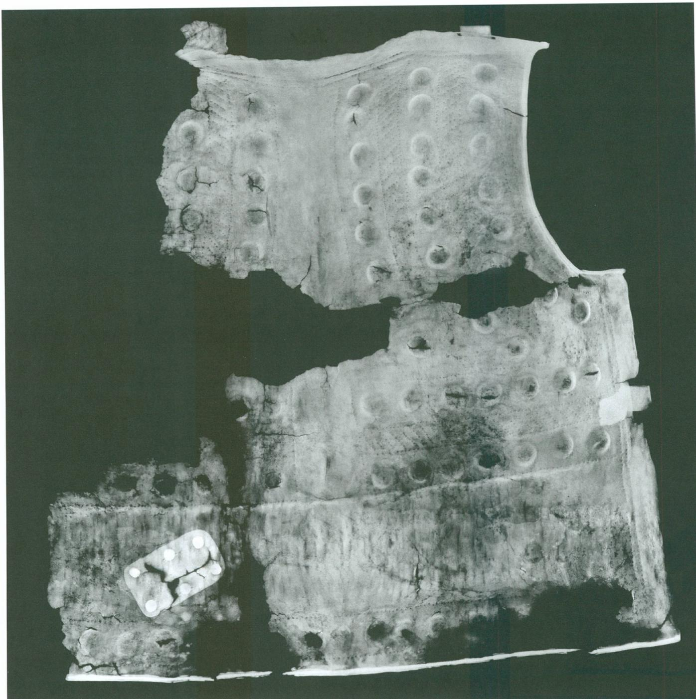
5. Assemblage des radiographies prises à haut kilovoltage mettant en évidence l'état de la tôle métallique: on peut y observer l'emplacement des lacunes, les fissures, le degré de minéralisation et les traces de martelage | Radiographies. 95 kV, 3,5 mA, 2"; assemblage au scanner et restitution Team Color
