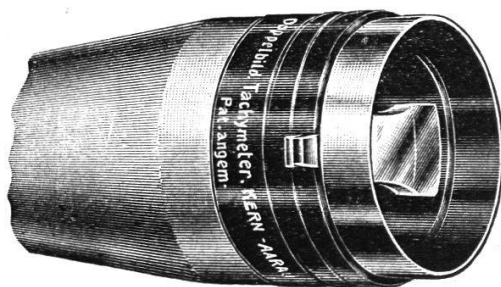
Fig. 1. Objektivende des Fernrohres mit aufgesetztem Doppelbildprisma.
