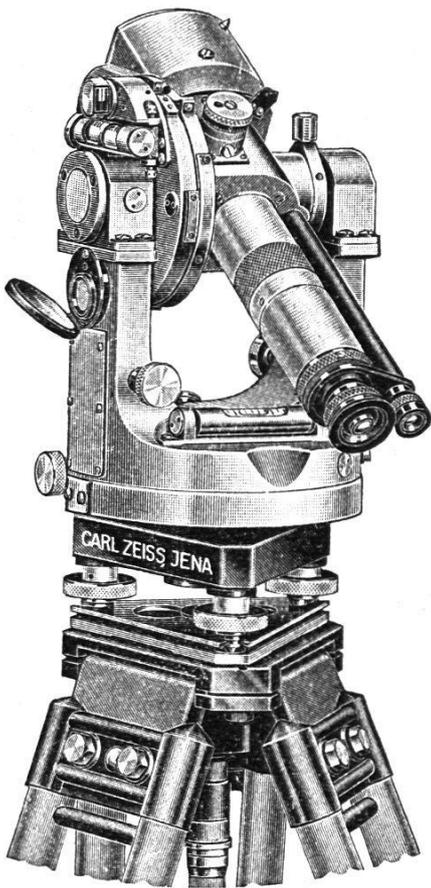
Optischer Präzisionsdistanzmesser für Polygonierung und Stückvermessung
