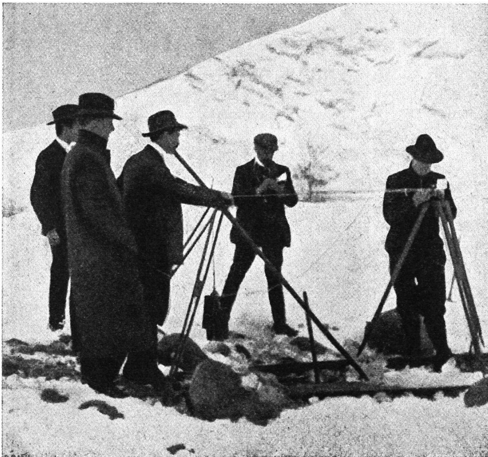
Fig. 22. Drahtbock und Indexstativ (repère mobile) für die Basismessung mit Invardraht.
