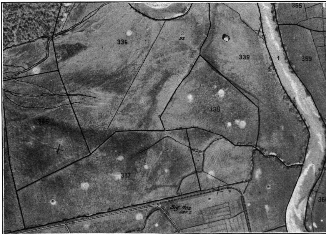
Fig. 2. Ausschnitt aus Original-Katasterplan Sihlseevermessung; einfarbige Reproduktion; Original im Maßstab 1 : 2000 (Entzerrung)
