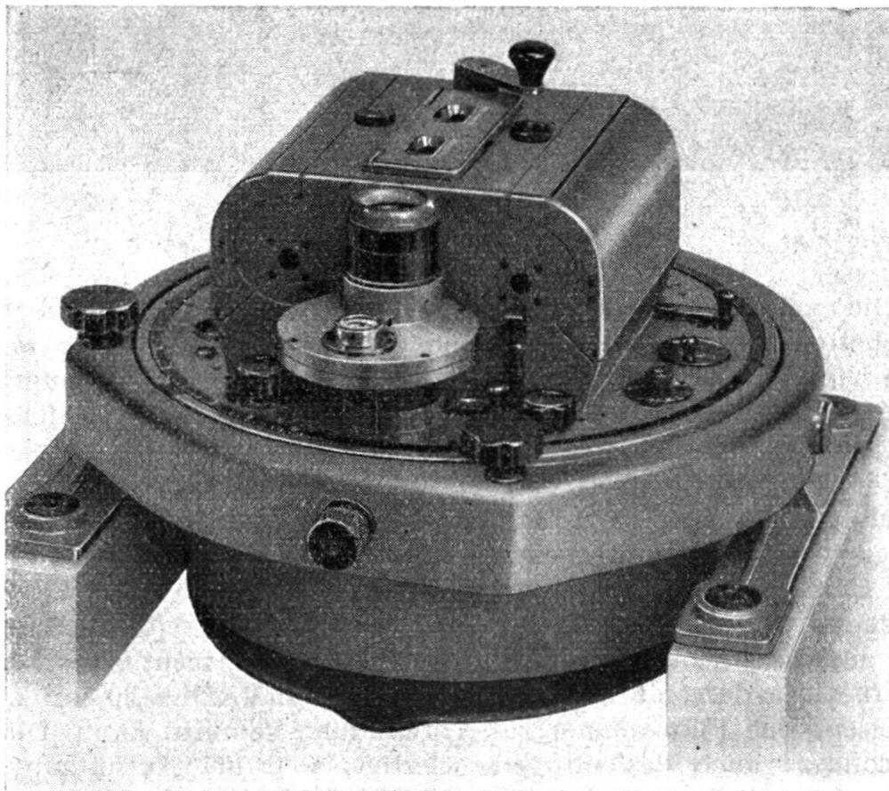
Fig. 4. Automatische Filmkammer
