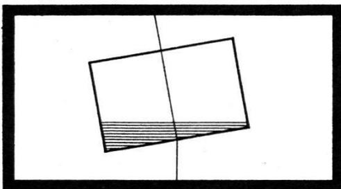
Der Strahlengang des Höhenkreis-Mikroskopes wird beim Wild T1-A durch ein Flüssigkeitsprisma geleitet und derart gebrochen, dass bei waagrechtter Sicht auch wirklich «100 g» abgelesen wird.
