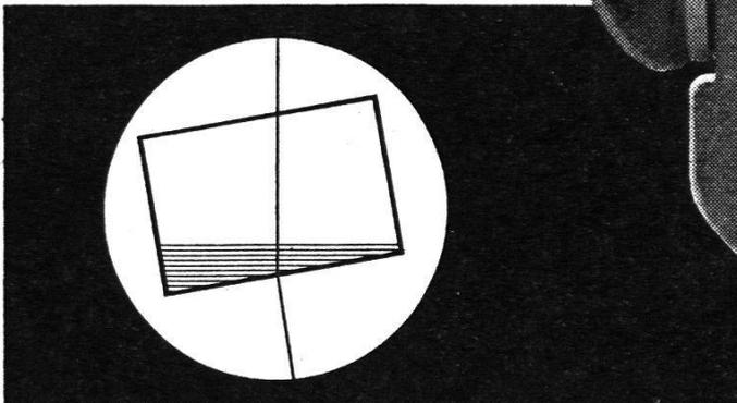
Verblüffend einfache Lösung der Automatik: Flüssigkeitsprisma ohne mechanische Teile, ohne Abnützung, ohne Störungen, ohne Reparaturen.
