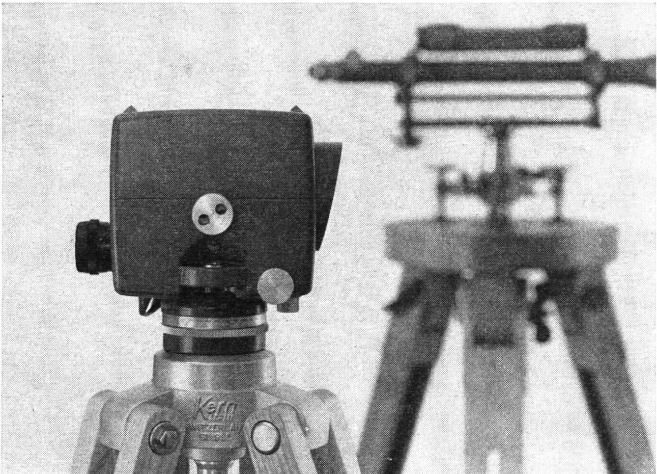
Mit dem Kern GK 1-A geht die Arbeit rascher voran, denn es besitzt nur noch zwei Bedienungsknöpfe: Fokussiertrieb und Seitenfeinstellschraube. Vergessen ist das langwierige Horizontieren mit den drei Fußschrauben, vorbei das Einspielen der Fernrohrlibelle vor jeder Messung. Kern-Automatik und Kern-Gelenkkopfstativ: die ideale Kombination für einfachere und schnellere Arbeitsweise.
