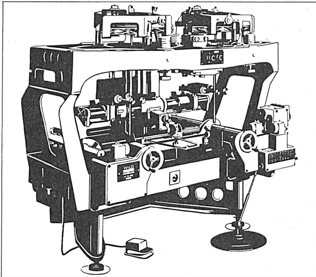
Der **Autograph Wild A7** ist ein Universalgerät 1. Ordnung für Aero triangulationen und Kartierungen in allen Masstäben aus Luftbildern und terrestrischen Aufnahmen bis zum Format 23 cm x 23 cm (9" x 9") und mit einem Bildweitenbereich von 98 bis 215 mm. Elektrische Koordinatenregistrierung mit dem Wild EK5
