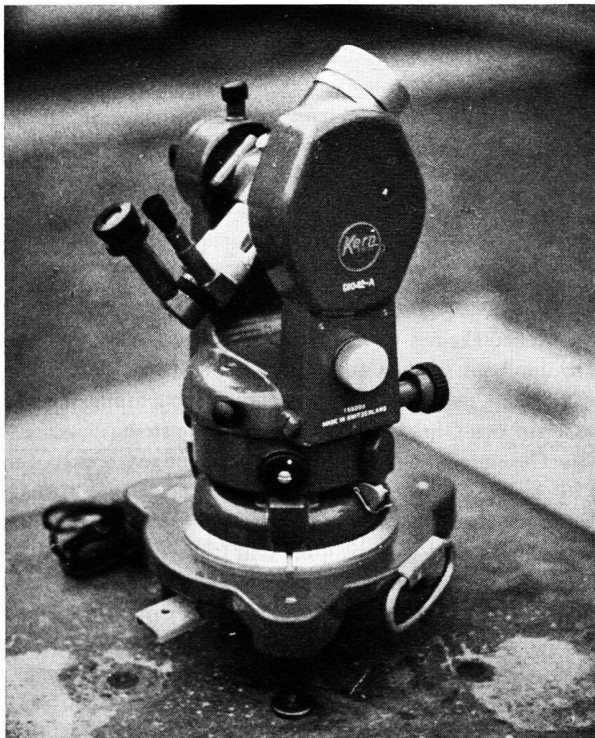
Abb. 1 DKM 2-A mit angebrachten gebrochenen Okularen
