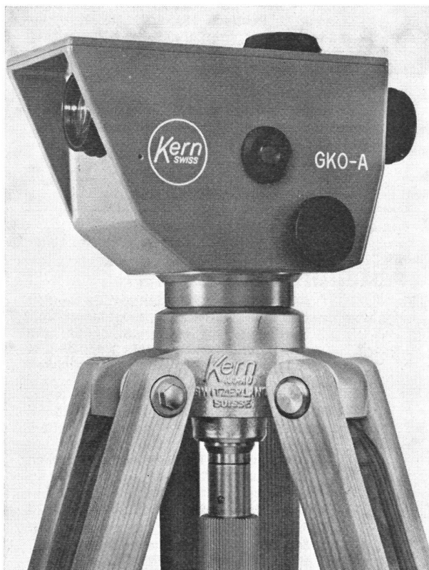
Abb. 1 Automatisches Baunivellier Kern GKO-A auf dem Gelenkkopfstativ
