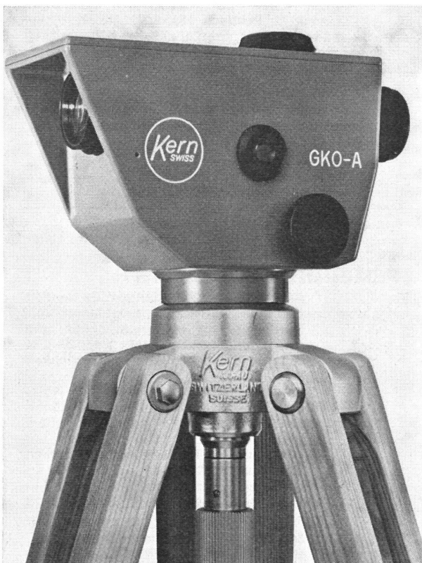
Abb. 1 Automatisches Baunivellier Kern GKO-A auf dem Gelenkkopfstativ
