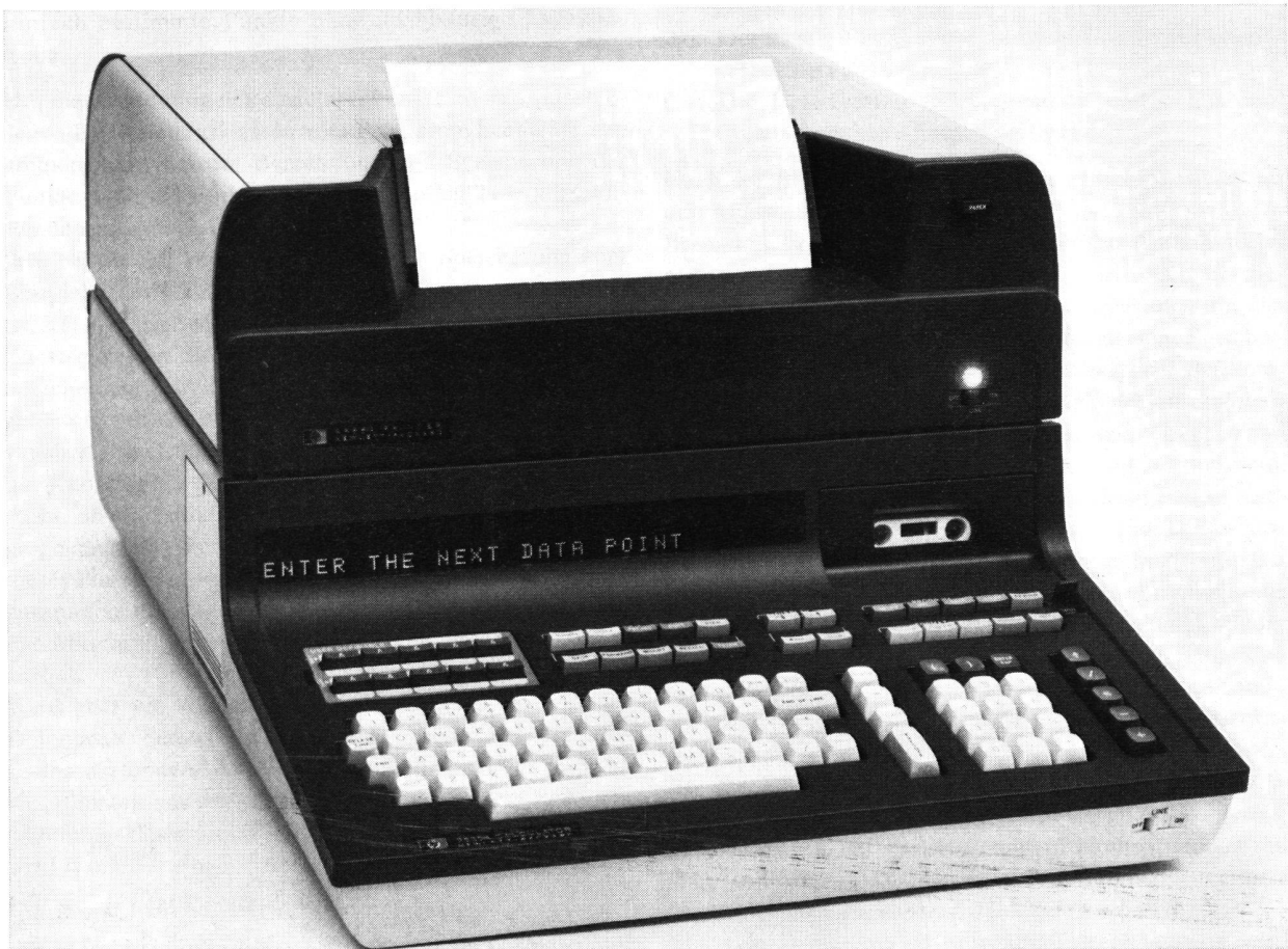
Abb. 1 Tischcomputer HP 9830 A mit aufgesetztem Thermoprinter 9866 A
