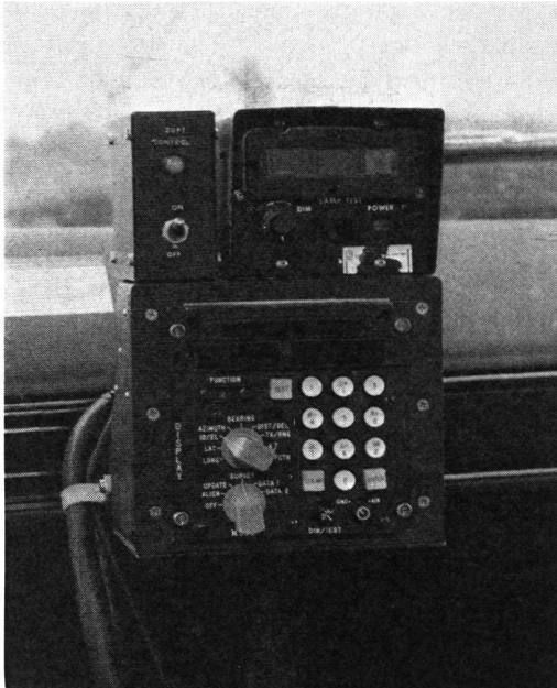
Abb. 2 Anzeige- und Kontrolleinheit im Fahrerraum des Messfahrzeuges.
