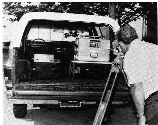
Abb. 3 Übernahme eines Azimutes aus der Trägheitsmesseinheit mit Hilfe eines exzentrisch aufgestellten Theodoliten.
