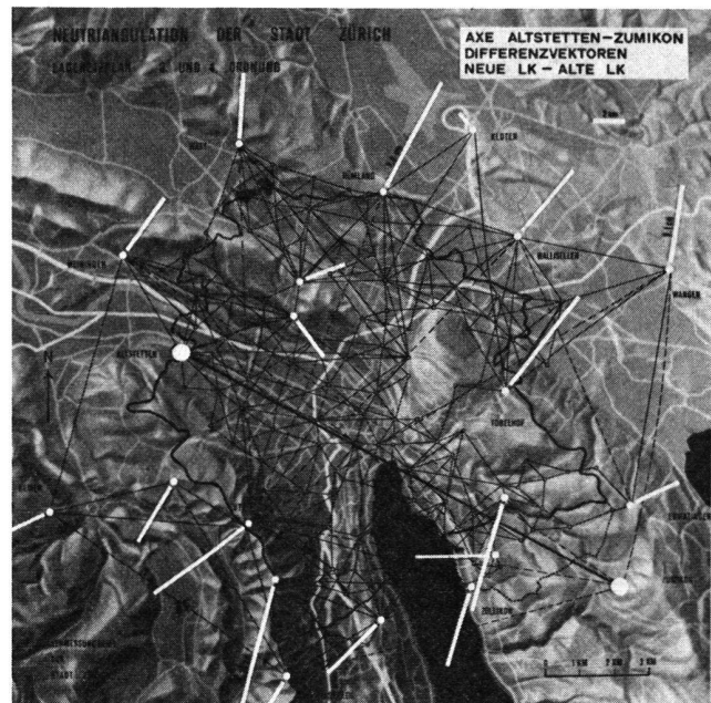
Abb.3 Als zweite Basis eignet sich die orthogonal zur ersten angeordnete mit den Punkten Altstetten-Zumikon. Interessant sind die aus dem örtlichen Verbund ausbrechenden Punkte Kloten und Witikon (unter dem Punkt Tobelhof).
