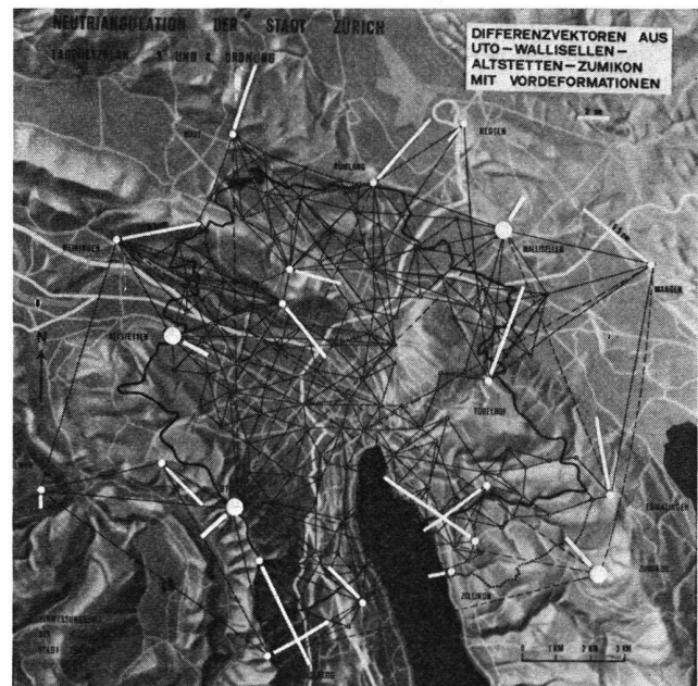
Abb.4 Mit einer Verkürzung bzw. Verlängerung der beiden Basen um 5 cm wird das Netz nahezu spannungsfrei über 4 Punkte gelagert (vgl. Abb. 2 und 3). Das Verhalten der freigelassenen Randpunkte ist nun soweit mit Sicherheit erkennbar, dass gesamthaft 10 Anschlusspunkte qualifiziert werden können; die restlichen bleiben Neupunkte.
