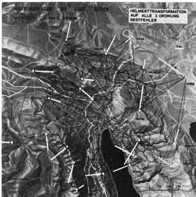
Abb.1 Mit den Anschlusspunkten Uto und Wallisellen wird das kombinierte Netz III. und IV. Ordnung ausgeglichen und auf 21 TP III. Ordnung nach Helmert transformiert. Der Durchschnitt aller Restfehlervektoren beträgt 4,5 cm.
