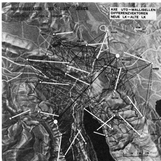
Abb.2 Nachdem eine verbindliche Beurteilung der Randpunkte mit den Ergebnissen der Helmert-Transformationen allein nicht ratsam ist, werden verschiedene Randpunkte paarweise und in Gruppen als Anschlusspunkte gezwängter Gesamtausgleichungen definiert. Gestützt auf nun bekannte Anschlussbedingungen können die jeweils freigelassenen Randpunkte qualifiziert werden. Als erster Schritt dient die Ausgleichung mit den Festpunkten Uto-Wallisellen.
