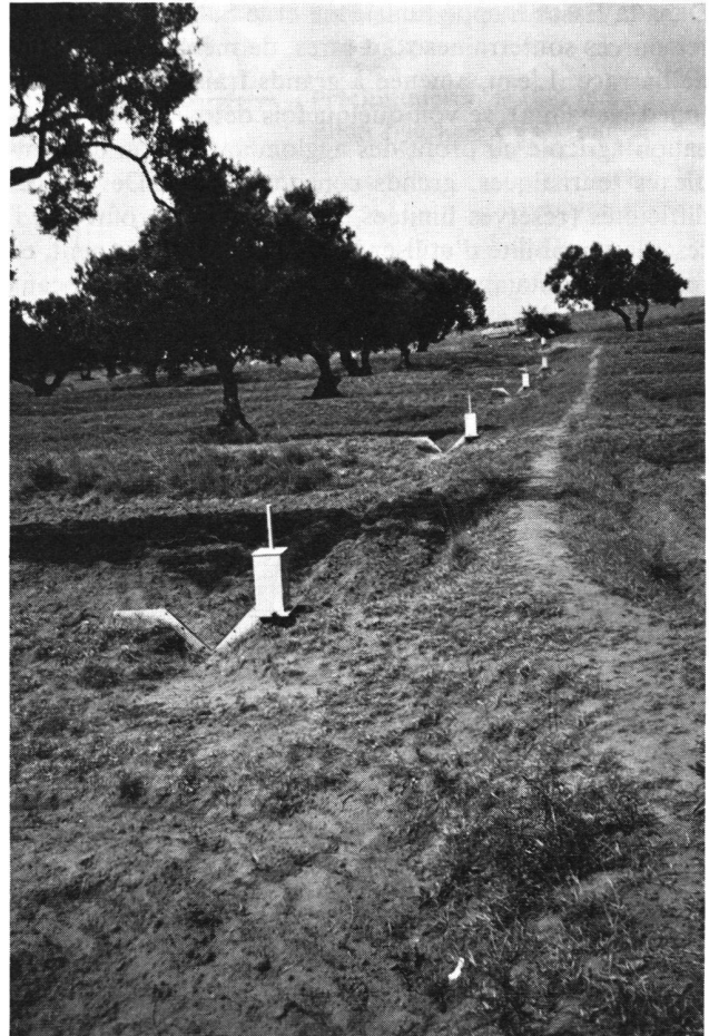
Figure 5 Limnigraphes enregistreurs (déversoirs) dans les olivettes, pour la mesure des débits de ruissellement. Les arbres sont dans des terrasses (manka) superposées.
