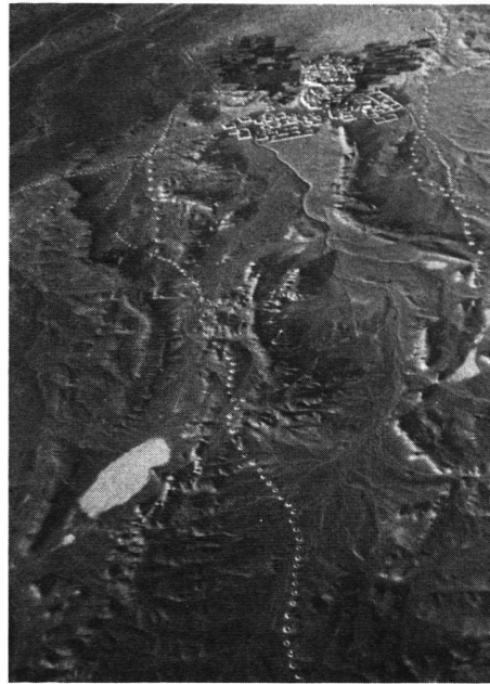
Fig. 3 Réseau de «Khanats» pour l'irrigation et l'alimentation en eau de boisson d'un oasis en Iran – vue aérienne à 10 000 m d'altitude
