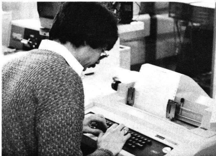
Station III: Schreibkonsole LA-36 für die Programmierung und Arbeiten mit Lochkartenleser, Magnetbändern, Zeilendrucker und Plotter
