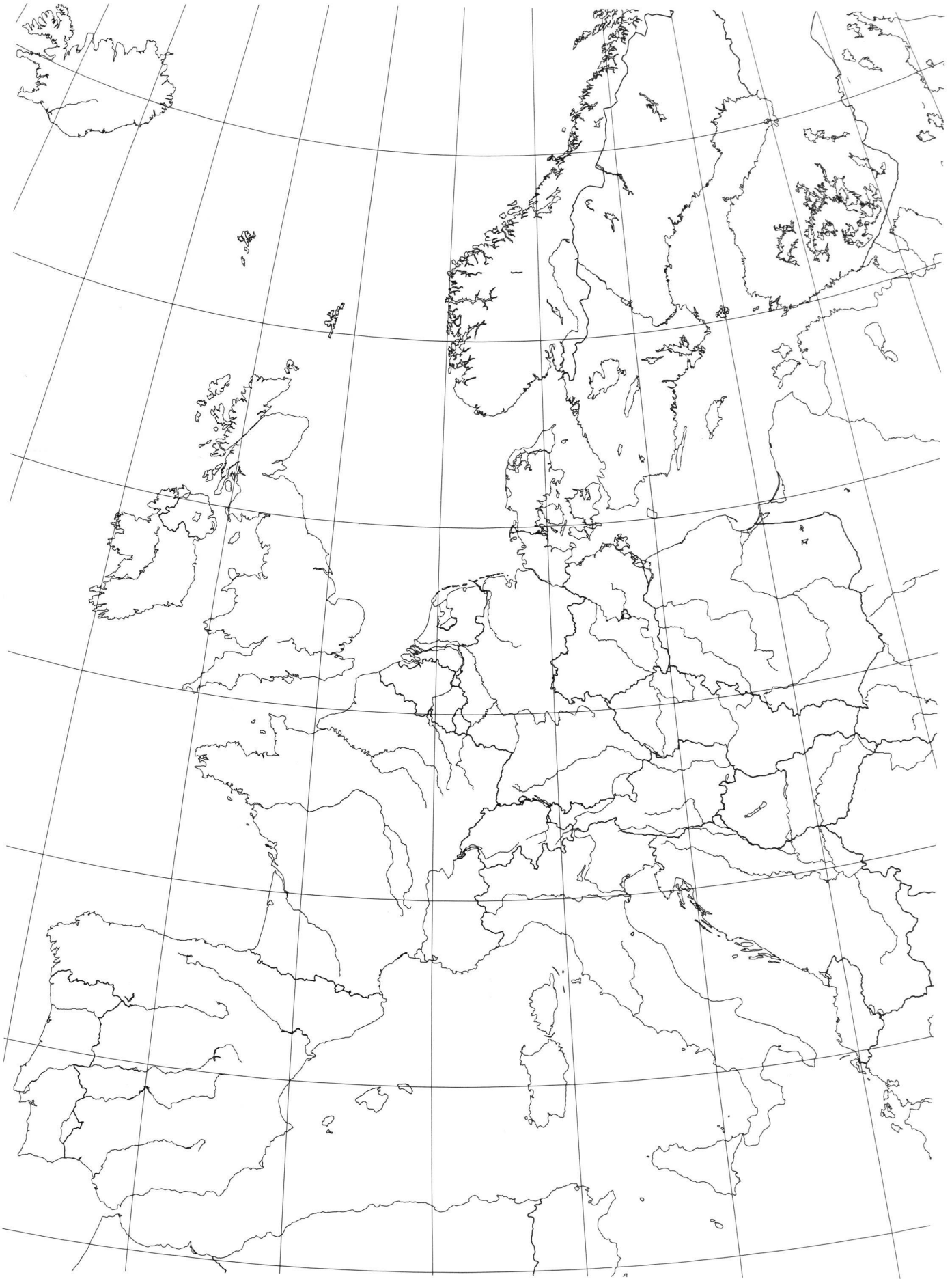
Abb. 2 Ausschnitt aus einer Europakarte in flächentreuer Azimutalprojektion, Kartenpol bei B = 50^\circ/L = 20^\circ , alles mit dem Lichtpunktprojektor in etwa 4 Stunden automatisch gezeichnet und 1:1 reproduziert.
