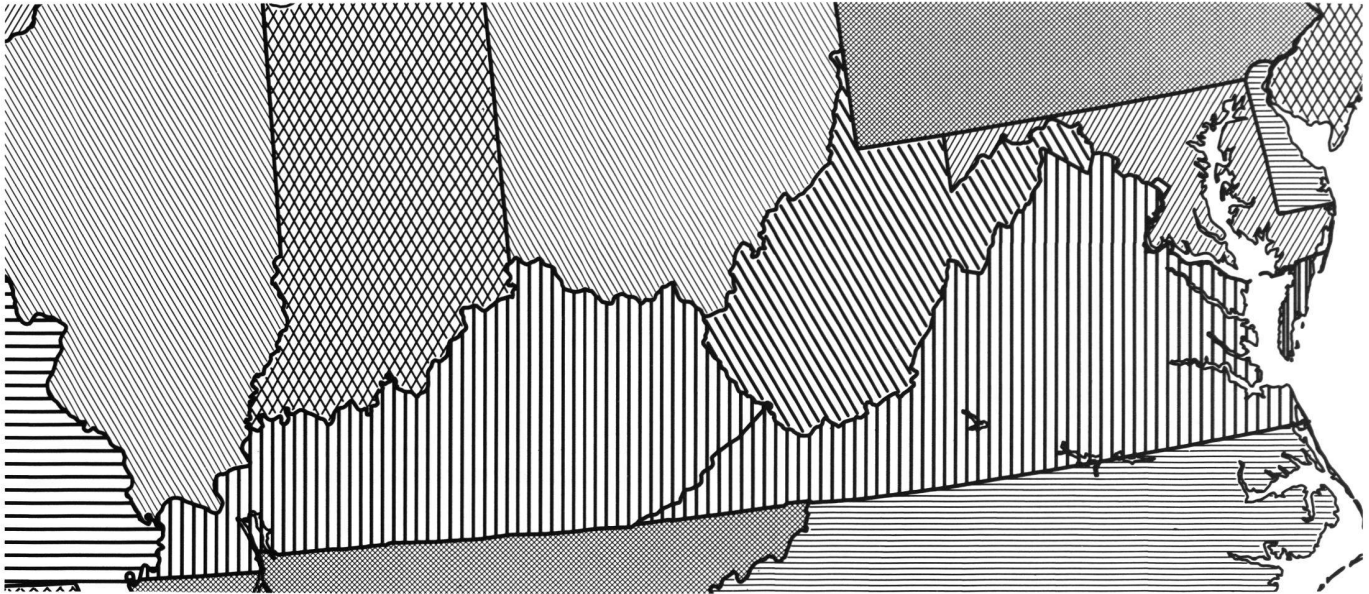
Abb. 5 Ausschnitt aus einer Zeichnung, welche in den USA mit dem neuartigen Kathodenstrahl-Filmbelichtungssystem «CRT 2000» von «Image Graphics Inc.» auf photographischem Film im Format 60 x 80 cm erzeugt wurde. Die Zeichenzeit für den hier 1:1 reproduzierten Ausschnitt betrug etwa 15 Sekunden. Dies ist beinahe hundertmal weniger als mit einem herkömmlichen Lichtpunktprojektor benötigt würde, obwohl dieselbe Genauigkeit und annähernd so gute Strichqualität erreicht wird.
