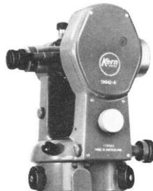
Kern E 1. Elektronischer Theodolit mit Registriergerät
