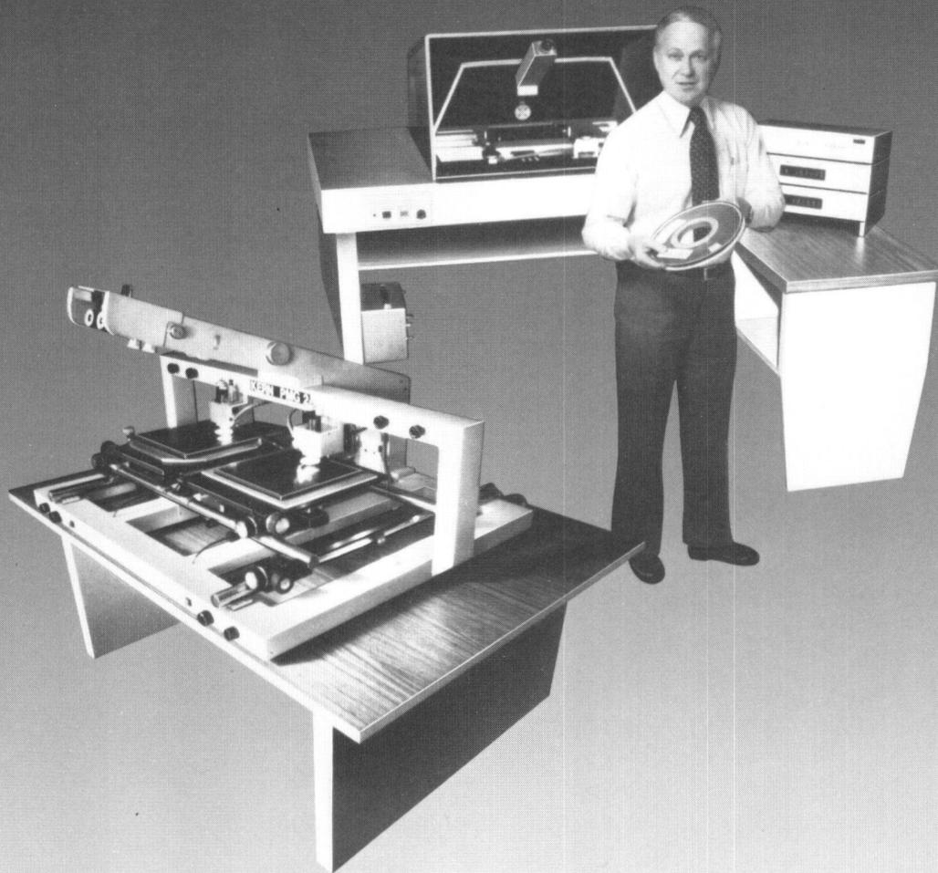
**PMG 2** Ein Zoom-Punktübertragungsgerät mit dem endlich eine Übertragungsgenauigkeit von wenigen  $\mu$  erreicht wird, eine Voraussetzung für die modernen Mess- und Rechenmethoden in der analytischen Aerotriangulation.
