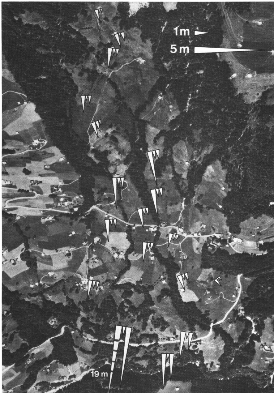
Fig. 2 Déplacement du terrain pour les périodes 1957-1969 (flèche gauche), 1969-1974 (flèche centrale) et 1974-1980 (flèche droite). La présentation se limite à une sélection des points. L'échelle des flèches indiquées se réfère à une période constante de 6 ans; ainsi, les mouvements mesurés pour 1957-69 ont été réduits de moitié. (Photographie reproduite avec l'accord de l'Office fédéral de topographie.)
