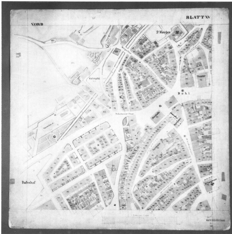
Abb.1 Das Planwerk der ersten amtlichen Vermessung bestand aus 42 Messtischblättern, Format 53 x 53 cm. Das Bild zeigt das Blatt XV.
