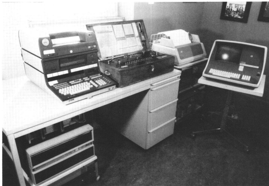
Der seit Mitte der siebziger Jahre in Betrieb stehende Rechner (Hewlett-Packard) und die erste Rechenmaschine im Vermessungsamt, ein (Millionär) um 1890.
