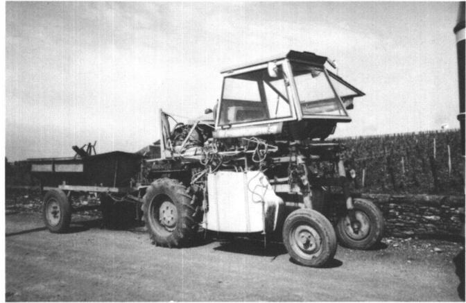
Abb.2 Ein «Stelzentraktor», der über die Rebzeilen hinwegfahren kann.
