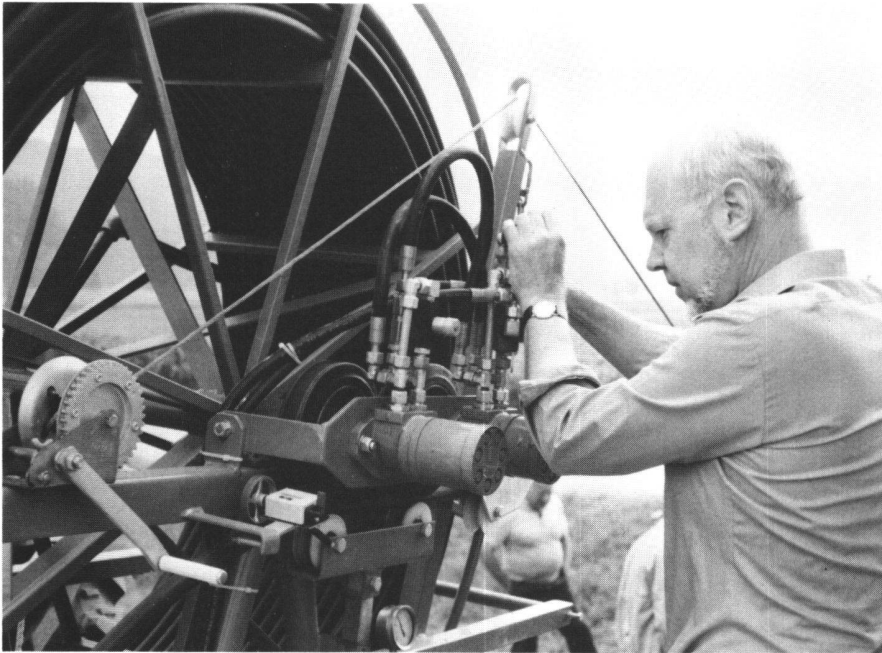
Abb. 5 Die Schalteinrichtung der Hydraulikanlage am Gerät «Junior» von Homburg. Links unter der Drehachse der Schlauchtrommel erkennt man das weisse Kästchen des Meter-Zählwerkes.
