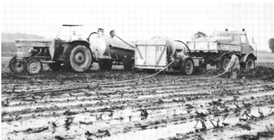
Abb. 4 Das Gerät «L100» von Barth-Holland im Einsatz. Obschon das Bild aus dem Firmenprospekt stammt, zeigt es ein sehr schlechtes Beispiel: In diesem Zustand dürfen die Felder nicht befahren werden.
