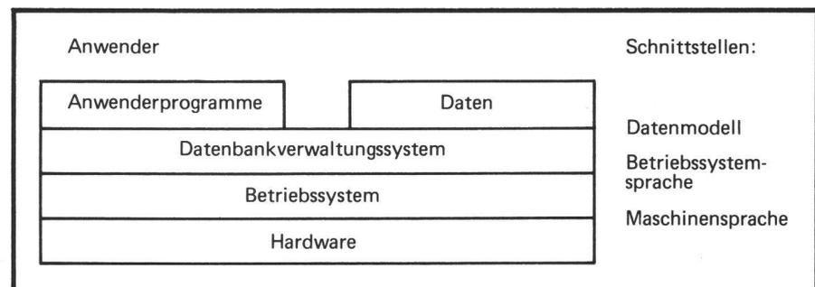
Abb. 1 Schichtenmodell eines Computers nach Zehnder [3]
