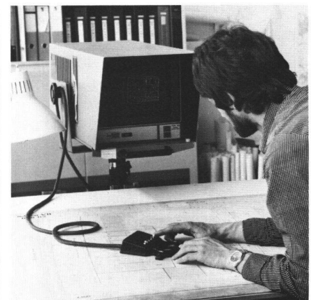
Abb.9 Die Digitalisierung der Grundbuchpläne ist der wichtigste Arbeitsschritt zur Realisierung des EDV-Mehrzweckkatasters
