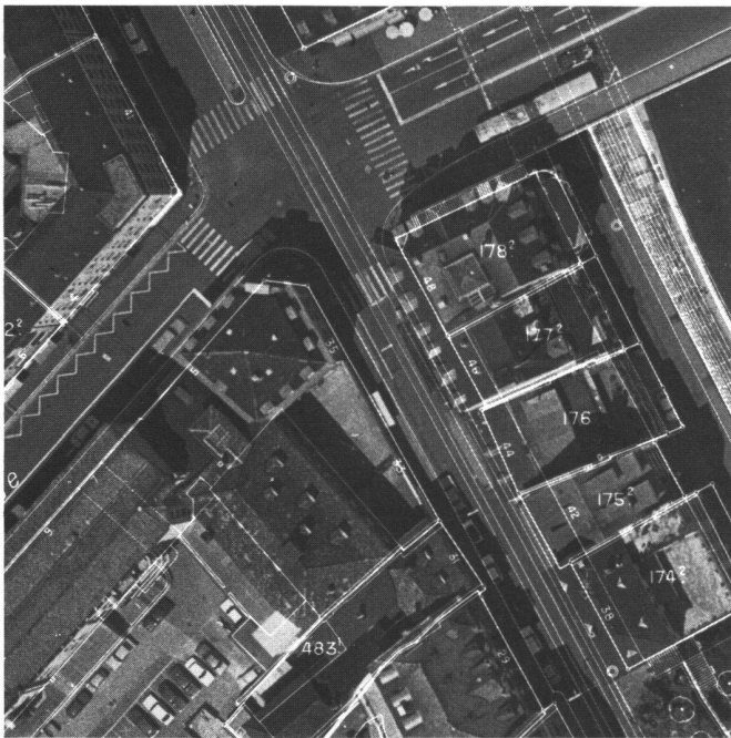
Abb.7a Kombination des Orthophotos 1:1000 mit dem digitalen, photographisch verkleinerten Mehrzweckkatasterplan
