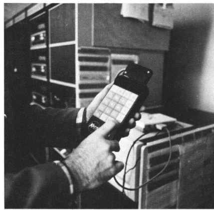
Abb.11 Die mit dem selbstregistrierenden Gerätesystem E1/R 48 erhobenen Felddaten werden in den Rechner zur Datenaufbereitung übertragen
