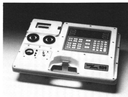
sche Anzeige und umfassende Software enthalten. In einer etwa einstündigen Messung erfasst WM101 die Daten der GPS-Satelliten, welche für die maximale Positionierungsgenauigkeit notwendig sind. Dies wird mit dem C/A-Code und Phasenmessungen von rekonstruierten Trägerwellen mehrerer GPS-Satelliten erreicht. Aus Daten, die gleichzeitig von zwei oder mehreren WM101-Einheiten an verschiedenen Standpunkten erfasst wurden, können durch die
