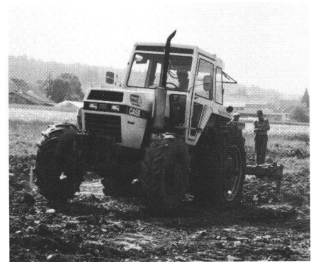
Abb. 6 Case 2090 mit Rabe Tieflockerer. Bei zu grossem Zugwiderstand hob sich der Schlepper mit den Vorderrädern vom Boden ab.
