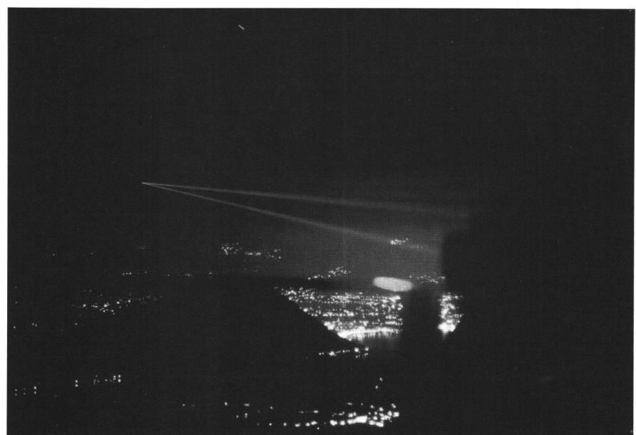
Abb. 8: MTLRS 2 beim Messen der Distanz Monte Generoso–Jungfrauoch. Die zwei Teilstrahlen entstehen durch Aufspaltung des Hauptstrahls. Das «blinde» Zentrum der Optik, wo ein Hilfsfernrohr zur Detektion von Flugzeugen oder der Sonne montiert ist, wird dadurch ohne Energieverlust ausgeblendet. Im unteren Bildteil sind die Lichter von Lugano sichtbar. Die Entfernung zum Jungfrauoch beträgt ca. 106 km.
