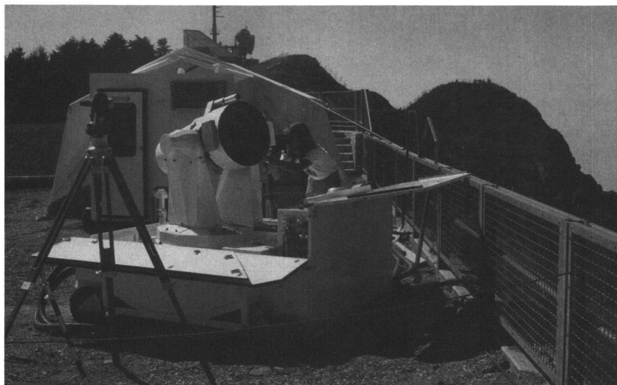
Abb. 5: Die eingerichtete MTLRS 2-Messstation auf Monte Generoso. Das Laserteleskop ist im Vordergrund sichtbar. In der klimatisierten Kabine sind die Elektronik und die Computersysteme untergebracht. Das Zelt dient als Stauraum und als Befehlswerkstätte für Reparatur- und Unterhaltsarbeiten.
