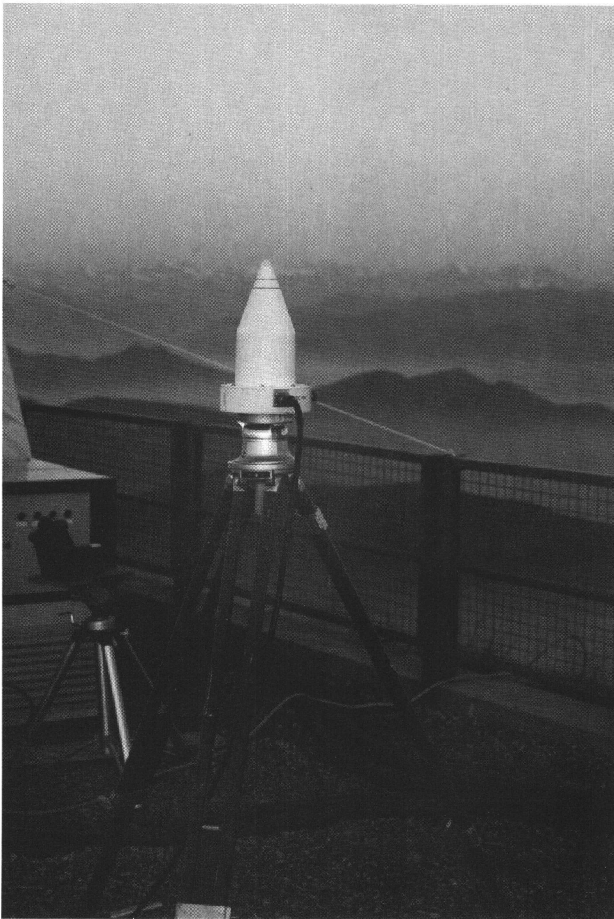
Abb. 9: GPS-Antenne (TI 4100) während der Messung auf Monte Generoso. Im Gegensatz zu den Lasermessungen, bei denen jeweils ein passiver Satellit angezielt wird, beruht das GPS-Verfahren auf der Messung von Radiowellen, die gleichzeitig von mehreren aktiven Satelliten empfangen werden.
