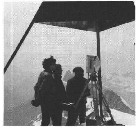
Abb. 1: Das Bild stammt aus dem Vertiefungsblock 1985, als von der Station Titlis im Netz 1. Ordnung Distanzmessungen mit Mikrowellen ausgeführt worden sind.
