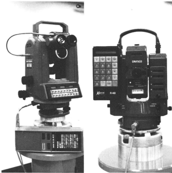
Datenerfassung: Registrierende Theodolite
