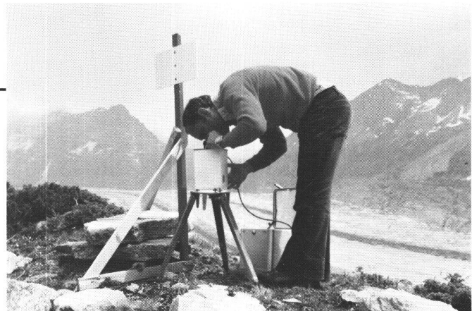
Gravimeter im Einsatz im Aletschgebiet
