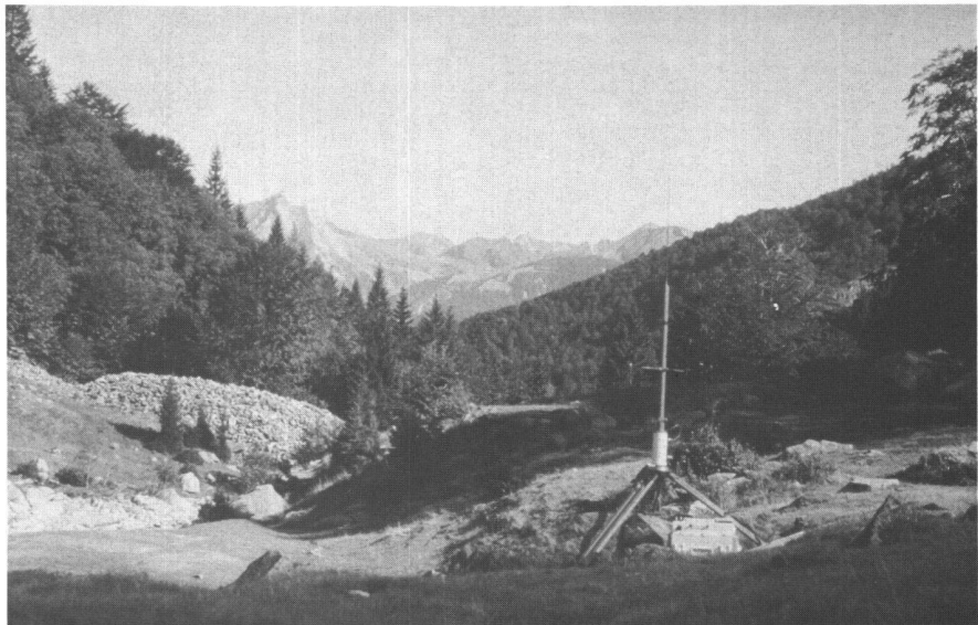
Abb. 3: TRANSIT-Dopplerempfänger im Valle Loana. Projekt des IGP zur satellitengestützten Bestimmung geodätischer Koordinaten.
