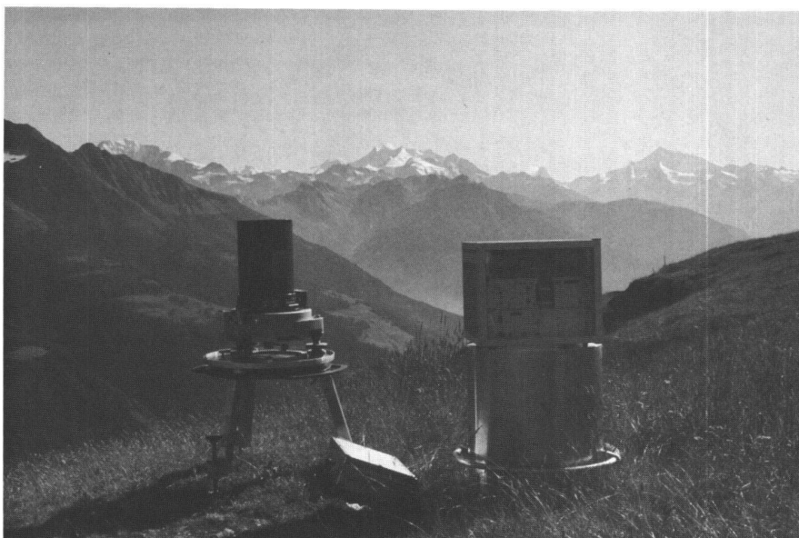
Abb. 2: Das Zenitkamera-Messsystem des Instituts für Geodäsie und Photogrammetrie (IGP) auf der Laxer-Alp.
