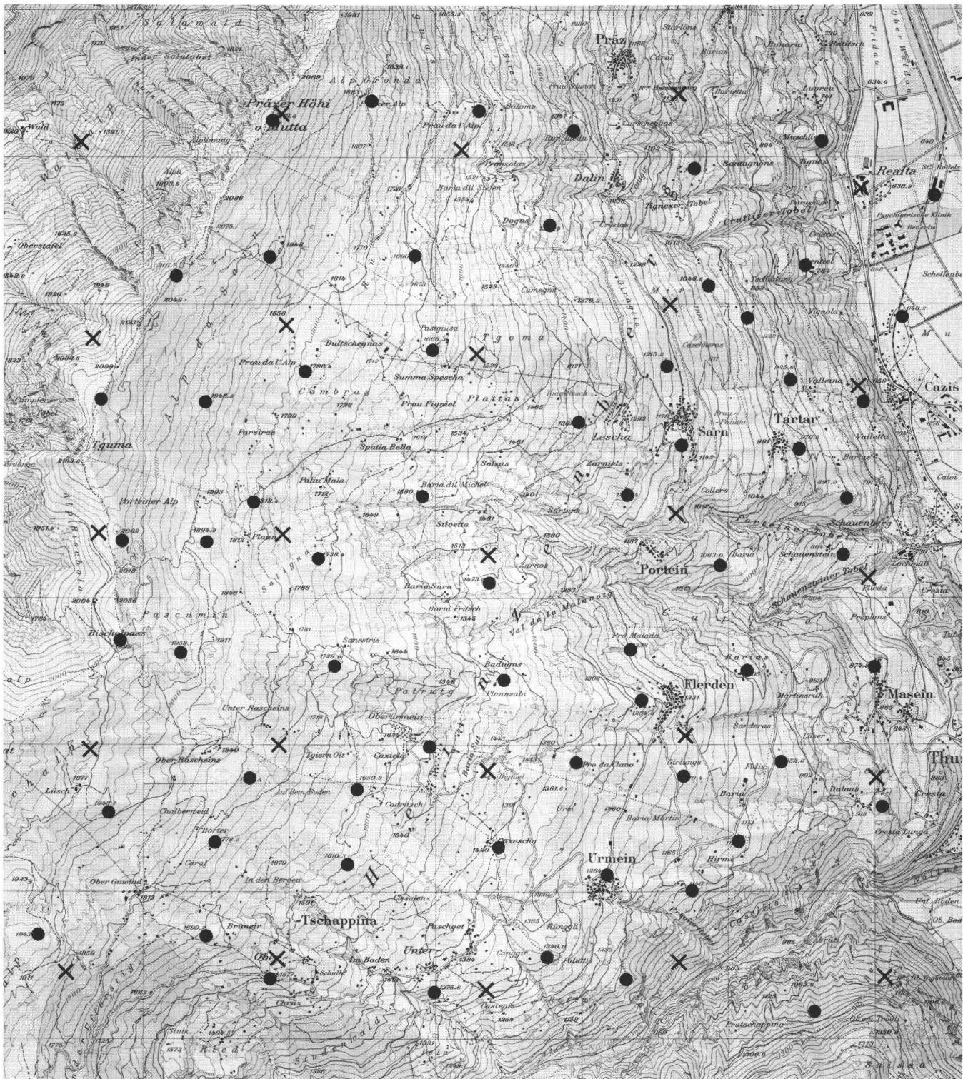
Abb. 2: Block «Heinzenberg». Verkleinerung aus LK 1:25 000 ● Netzpunkte (Pass- und Kontrollpunkte) x Nadirpunkte
