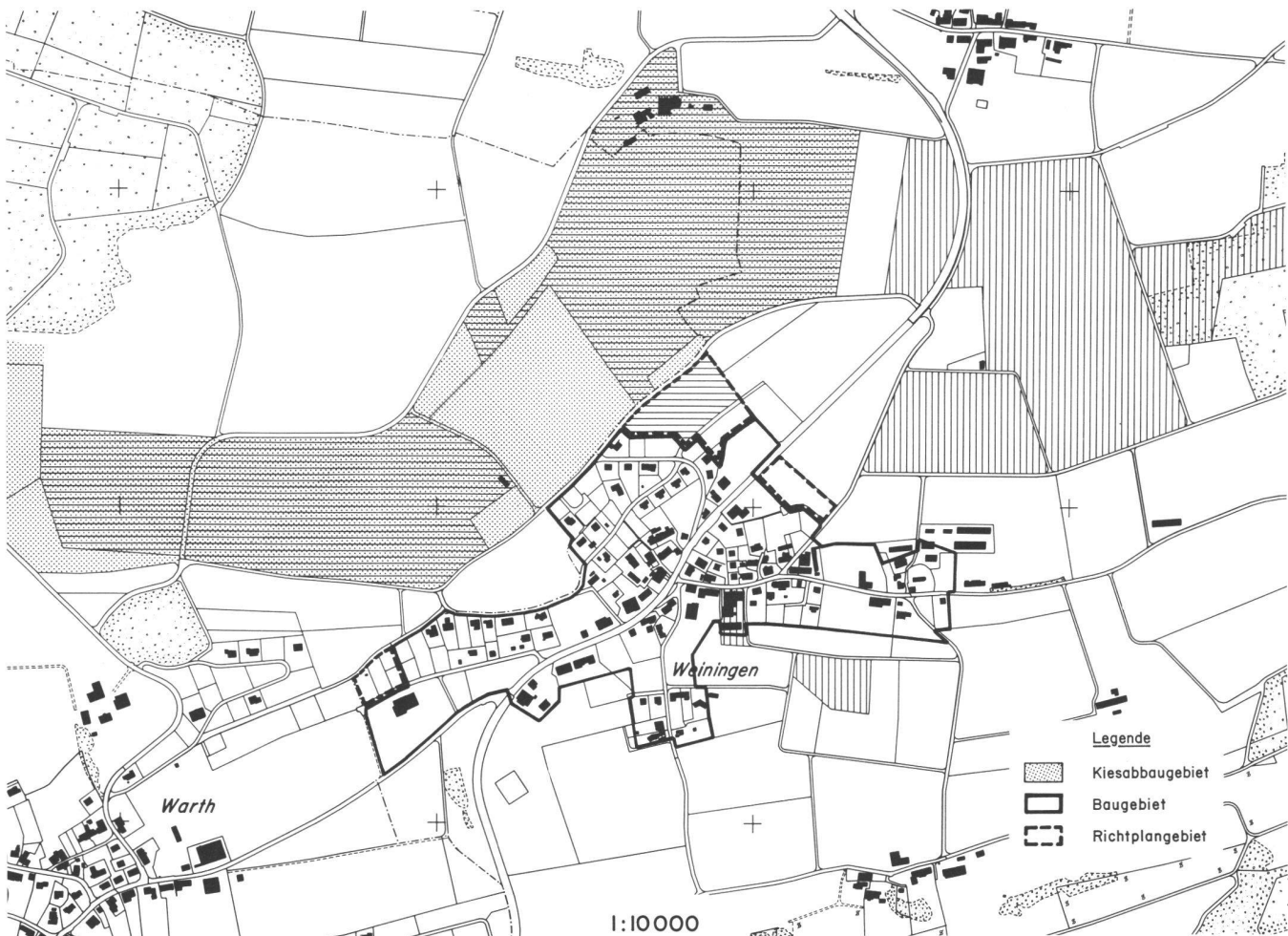
Abb. 3: Ausschnitt Neuer Besitzstand der Gesamtmelioration Warth-Weiningen TG. Landwirtschaftsbetrieb als Beispiel für die Entflechtung zwischen Bauland- und Landwirtschaftsinteressen. Kiesabbaubetrieb als Beispiel für die Entflechtung zwischen Landwirtschafts- und Kiesabbauinteressen.
