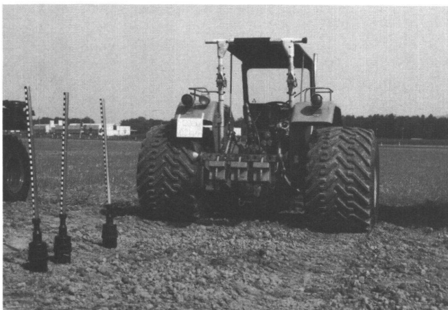
Abb. 2a + 2b: Unterschiedliche Bodenbelastung durch unterschiedliche Bereifung. Messung des Wasseraufnahmevermögens mit Infiltrationsrohren und des Eindringwiderstandes mit einem Penetrographen.
