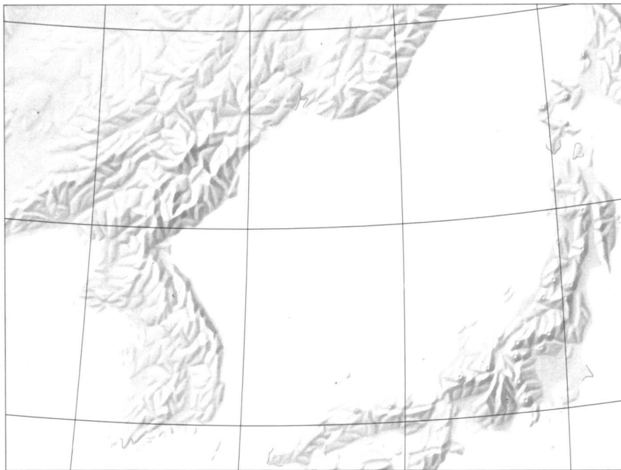
Abb. 2: Oben: Relieforiginal für die Karte Ostasien im Mittelschulatlas, Ausgabe 1976, auf äquidistanter Kegelprojektion entworfen. Unten: Dasselbe Relieforiginal für die Neuausgabe des Schulatlasses in flächentreue Azimutalprojektion transformiert.
