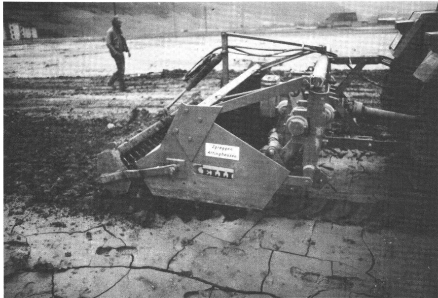
Abb. 1: Spatenmaschine im Einsatz in Andermatt. Man erkennt sehr gut, wie beim Traktor praktisch kein Schlupf auftritt.
