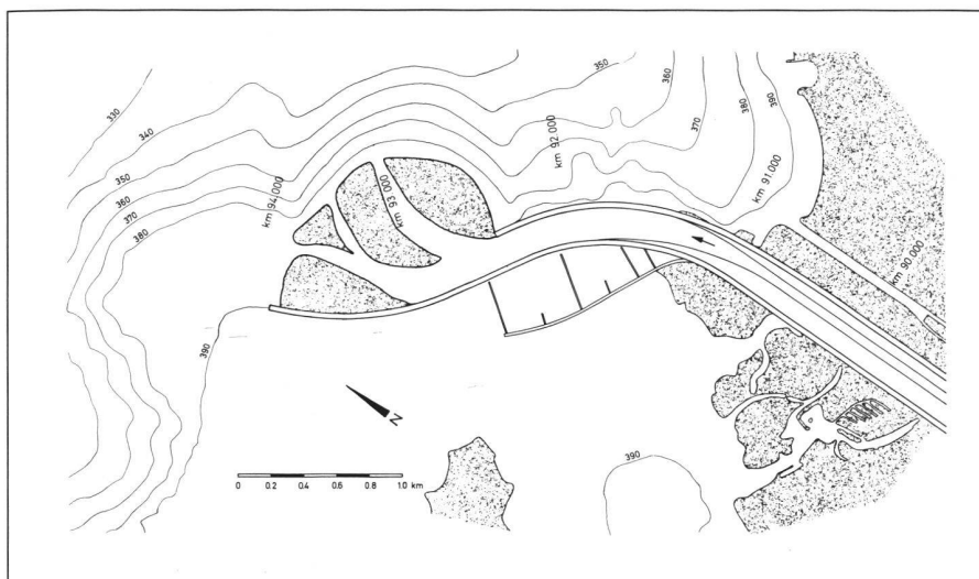
Abb. 4: Mögliche zukünftige Entwicklung der Rheinmündung bei einer Kombination der Kanal- mit einer Deltalösung.
