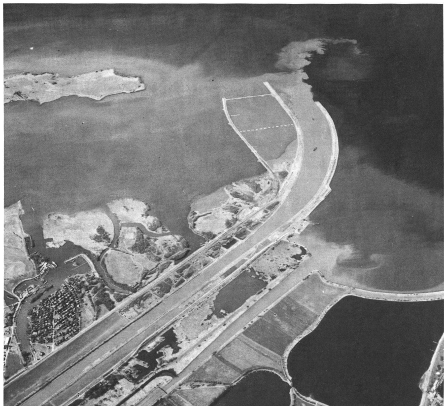
Abb. 6: Neue Rheinmündung: die Luftaufnahme vom Oktober 1986 zeigt die Vorstreckung der Hochwasserdämme, links die Fussacher- und rechts die Harder Bucht (Foto: Thorbecke).
