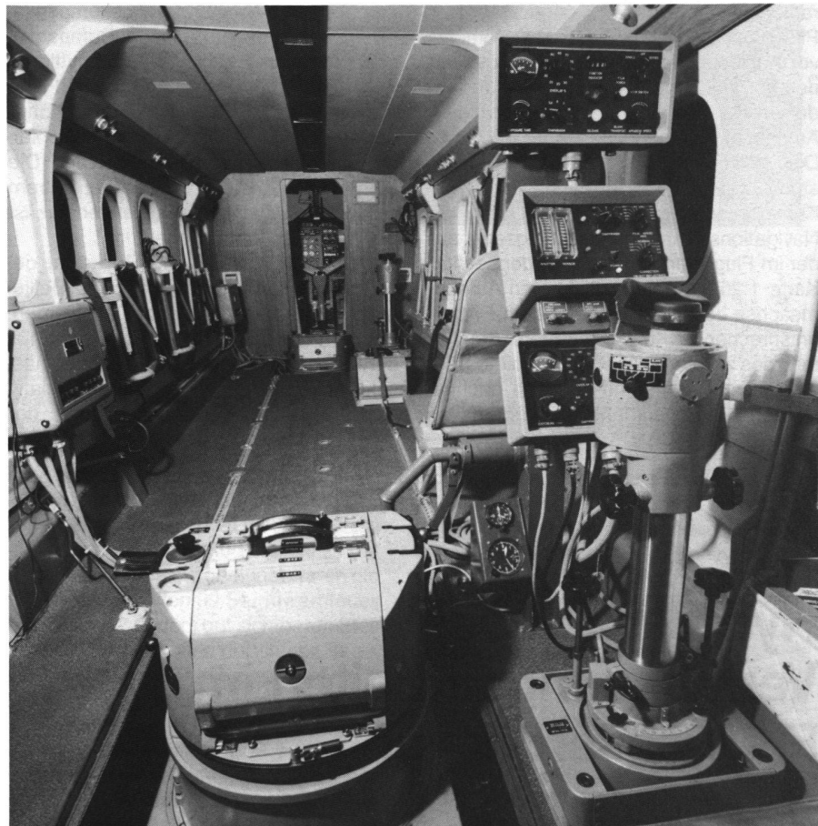
Abb. 2: Zwei Reihenmesskammern RC-10 im Flugzeug installiert. Aufnahme erstellt durch das Bundesamt für Militärflugplätze.
