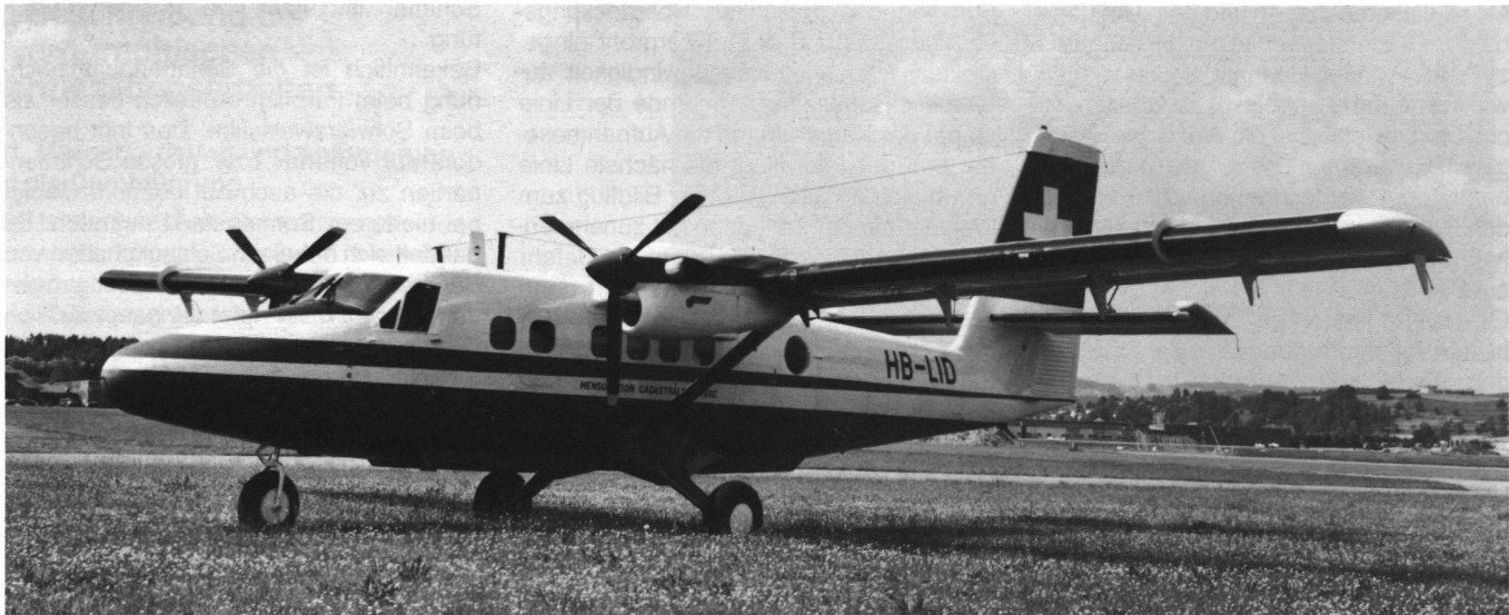
Abb. 1: Vermessungsflugzeug «Twin Otter», Typ DHC-6-300. Aufnahme erstellt durch das Bundesamt für Militärflugplätze.
