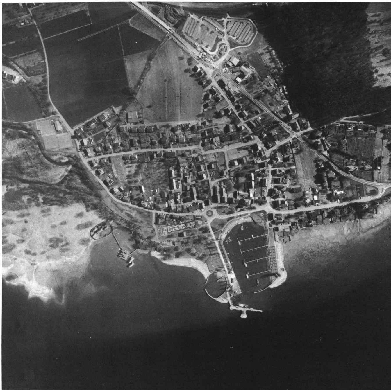
Abb. 1: Luftbild Bodenseetiefenvermessung – Flachwasserbereich. Originalmassstab 1:5500, ca. 1,5fach verkleinert. Dargestelltes Gebiet: Unteruhldingen. (Freigegeben durch das Landesvermessungsamt Baden-Württemberg Nr. 27/86 vom 12.5.1986)
