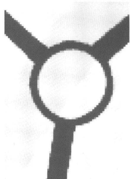
Abb. 4: Grauwertabtastung, 4 Graustufen / Quantification avec 4 valeurs de gris
