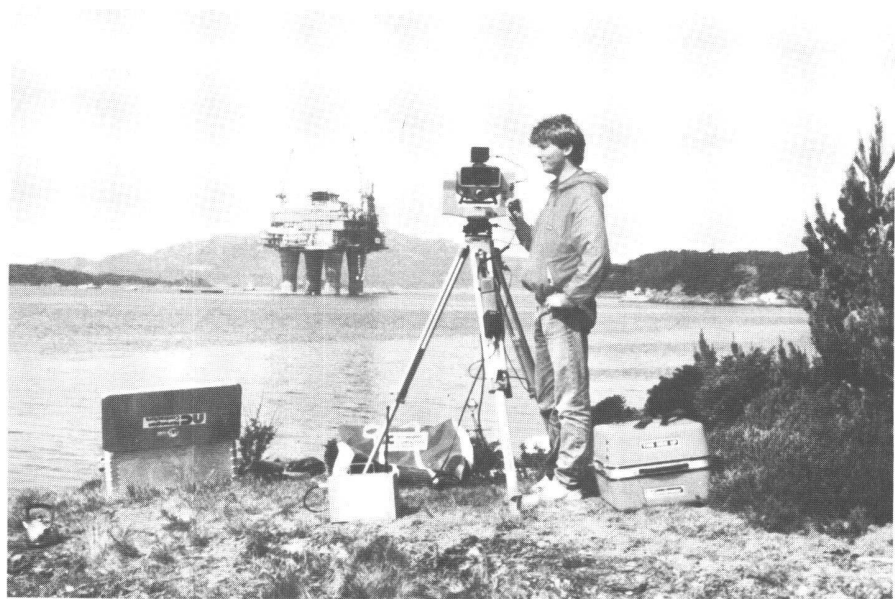
Abb. 1: Im Sommer 1988 wurde ein Geodimeter 140T zur kontinuierlichen Positionsbestimmung bei der riesigen Ölförderplattform Oseberg «A» eingesetzt. Die 224,7 m hohe Betonkonstruktion wurde aus einem engen Fjord bei Stavanger zu einem Ölfeld in der Nordsee geschleppt.
