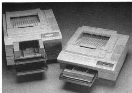
Die Laserdrucker DEClaser LN05 und LN06 lassen sich für sehr vielfältige Druckaufgaben einsetzen. Texte und Grafiken werden gestochen scharf mit einer Auflösung von 300×300 Punkten pro Zoll ausgegeben. Die maximale Druckgeschwindigkeit beträgt acht Seiten pro Minute. Der DEClaser LN06 verfügt über zusätzliche Fähigkeit, Papierblätter beidseitig zu bedrucken. Neben Einzelblättern in verschiedenen Formaten verarbeiten die beiden Laserdrucker auch Etiketten, Präsentationsfolien und Briefumschläge.
