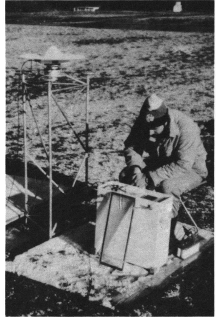
Abb. 7: Vor der eigentlichen Messkampagne im Netz wurden alle eingesetzten Empfänger auf der Teststrecke der L+T in Thun geprüft und die individuellen Offsets der Phasenzentren für alle Antennen bestimmt. Auf dem Bild ist auch ein Stahlpfeiler für die stabile Montage der Antennen zu erkennen.
