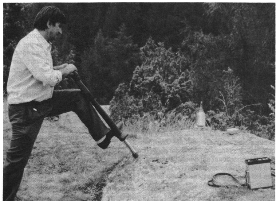
Abb. 3: Dynamischer Stabilitätstest nach der Methode von Dr. N. Pavoni (Inst. für Geophysik, ETH Zürich). Dabei wird das zu prüfende Felsobjekt mechanisch angeregt und die induzierte Schwingung mit einem Geophon gemessen.
